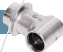
Albero porta-utensile in acciaio legato, temperato e con doppio labirinto. Completamente rettificato, con tolleranze inferiori ai 5 micron, per garantire una durata maggiore dell'utensile in lavorazione.
