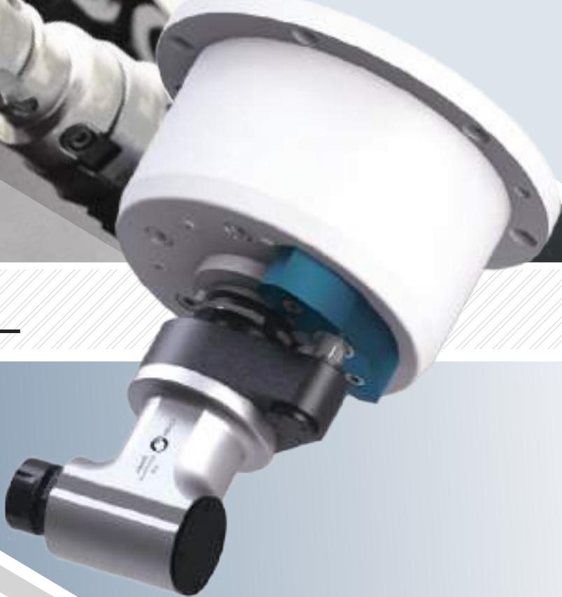
La LINEA CONTROL comprende una serie di teste angolari adatte ad essere montate nel magazzino utensile e quindi essere scambiate automaticamente. La corretta installazione prevede il montaggio di uno stop block a bordo macchina. Per una maggior rigidità il cono di attacco alla macchina è realizzato in un unico pezzo con l'albero principale.
