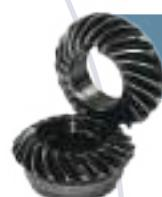
Ingranaggi realizzati in superlegghe di acciaio, temperati e interamente rettificati. Vengono trattati con lucidatura isotropica che conferisce loro una rugosità pari a 0,01 Ra e un abbattimento notevole delle vibrazioni e dell'attrito.
