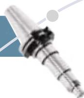
Corpo testa in ghisa sferoidale GS-600 stabilizzata per un assorbimento totale delle vibrazioni. Stabilità termica e rigidità superiori ad altri materiali (es. acciaio e alluminio). Cromatura opaca sul corpo e sedi dei cuscinetti interamente rettificate.
